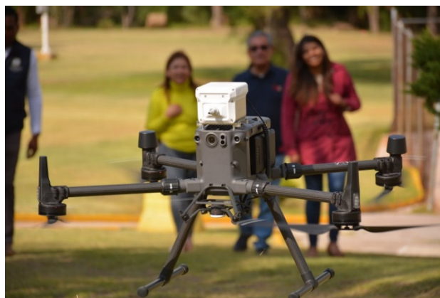
Imagen 8. Sniffer montado en drone Matrice 300
