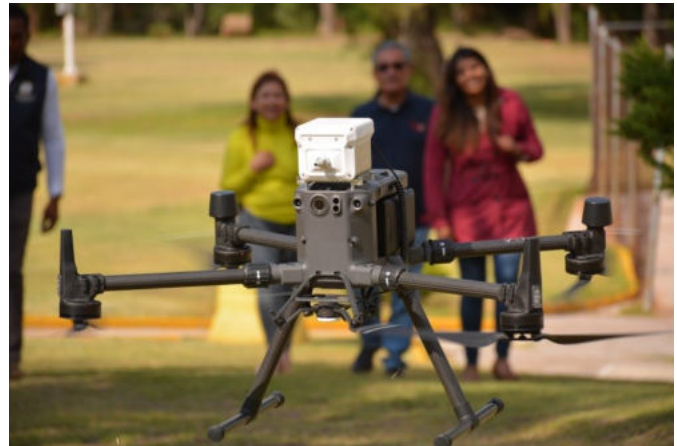
Imagen 3. Sniffer montado en dron e Matrice 300. Imagen tomada del acervo fotográfico del Laboratorio de Análisis territorial Ambiente y Ciencia de Datos.
