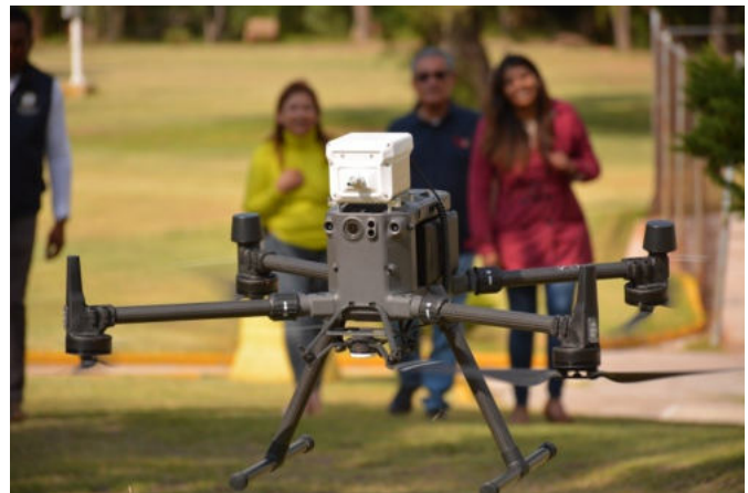
Imagen 3. Sniffer montado en dron Matrice 300. Imagen tomada del acervo fotográfico del Laboratorio de Análisis territorial Ambiente y Ciencia de Datos.
