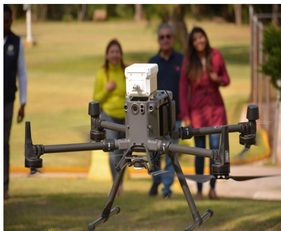
Imagen 3. Sniffer montado en drone Matrice 300.
