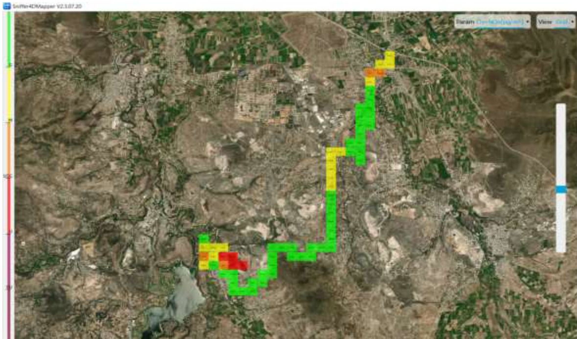
Imagen 5. Mapeo final de contaminantes en plataforma Sniffer4DMapper, Tula de Allende – PTAR Atotonilco de Tula.
