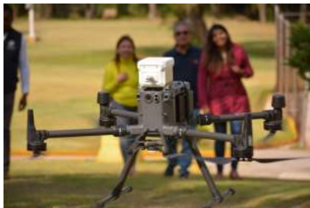
Imagen 3. Sniffer montado en dron Matrice 300
