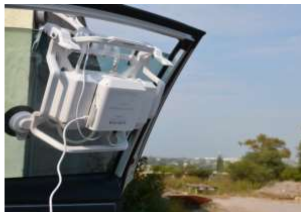
Imagen 2. Sniffer montado en vehículo
