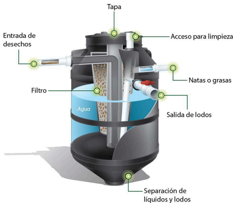
Ilustración 4. Funcionamiento del Biodigestor
