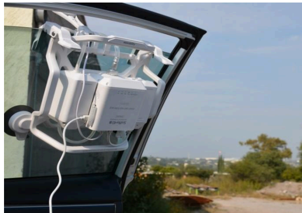
Imagen 7. Sniffer montado en vehículo
